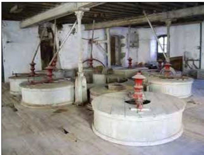
Fig. 11. La sala de piedras de moler situada en el primer piso del complejo industrial de La Alianza, en Puente Genil, constituye un buen ejemplo de las fábricas de harina movidas mediante turbinas, surgidas desde fines del siglo XIX (fot. J. Varela).
