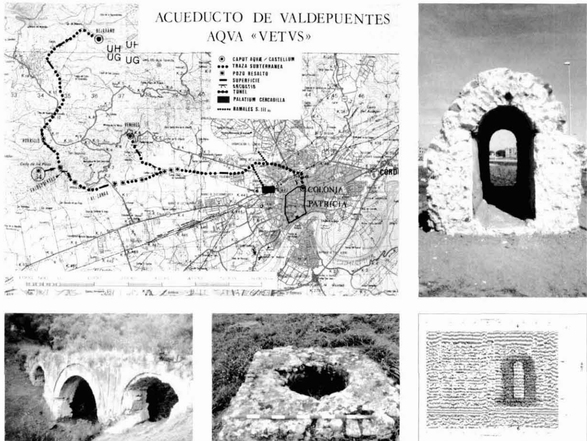
Figura 2. Plano de trazado del Acueducto de Valdepuentes y aspectos de su obra. Detalle de resultados de prospección con Geo-rádar de sus tramos subterráneos (sector del Parque Figueroa).
